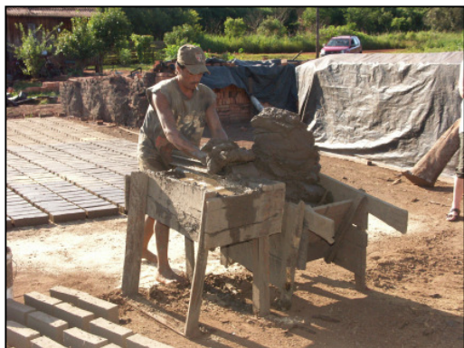
Die Form wird von Hand mit dem Lehm gefüllt
