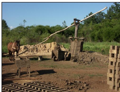
Die 4 Huf-/1 PS-Lehmmischmaschine
